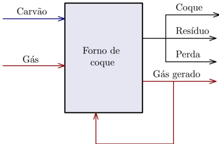
Figura 1: Processo de produção do coque
